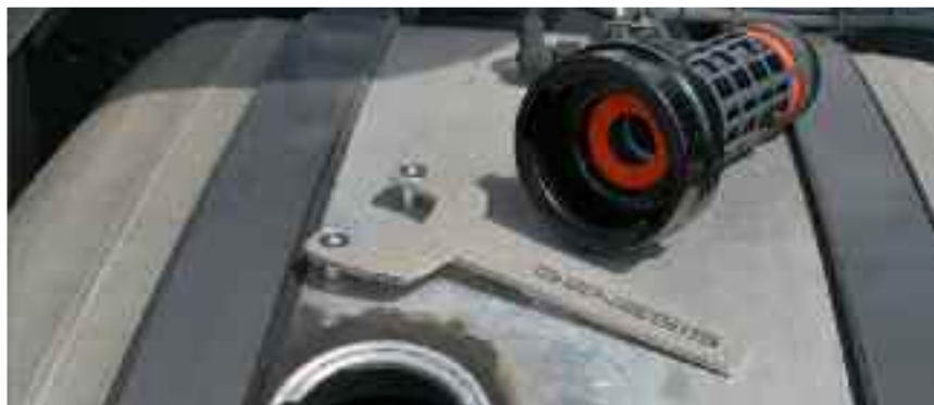
La chiave di fissaggio e il dispositivo Kockòn da montare sul serbatoio
